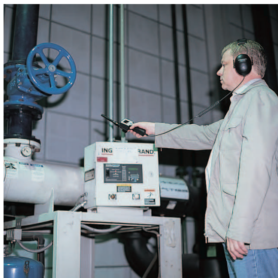
Detección de fugas con tubo de enfoque
